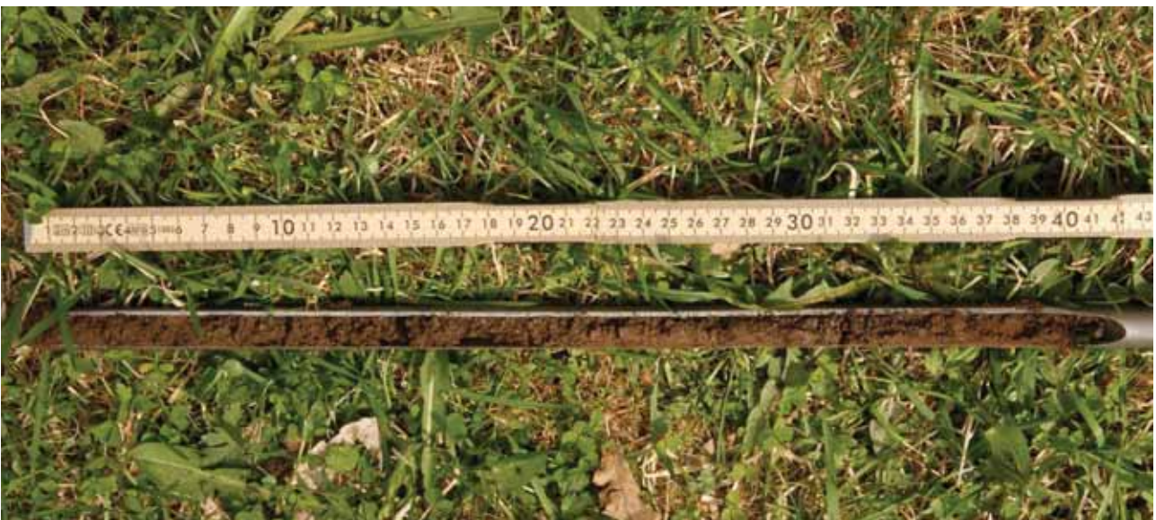
Kairanäyte B2 edustaa hyvin B -kairanäytesarjaa, joissa näytteissä esiintynyt maa-aines oli hiesun sekaista maa-ainesta. Kuva: TET-harjoittelija Mauno, Forssan mullankaivajat.
