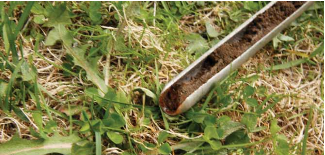
Kairanäytteessä B13 erottuu ruosteenpunaista sekoitteista maata aivan näytteen syvimässä 39-40 cm osassa. Kuva: TET-harjoittelija Mauno, Forssan mullankaivajat.
